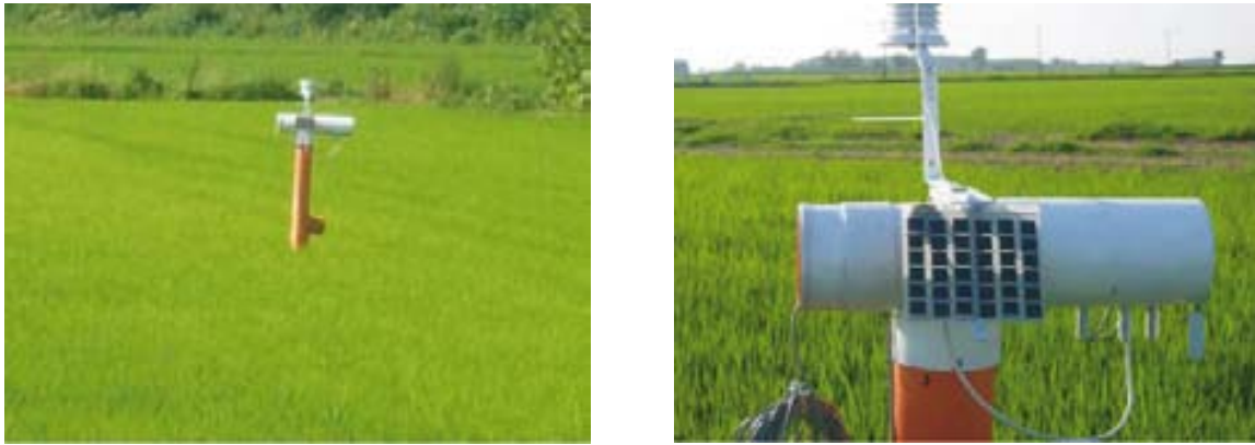
Fig. 2 - System T per il monitoraggio continuo del livello dell'acqua in risaia, nonché della temperatura di acqua e aria (nella figura B, si può notare un particolare della "T")
