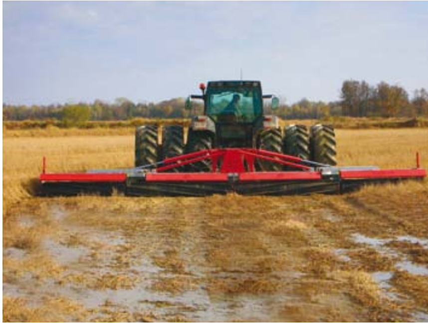
Fig. 6 - Prove di abbattimento dei residui pagliosi di riso con rullo compattatore/frantumatore "Rotolama" portato su trattore ad elevata portanza con ruote gemellate e pneumatici ad elevata sezione e bassa pressione di gonfiaggio. In figura: il primo trattamento su paglia in piedi.
