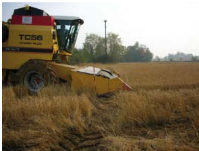
Fig. 3 - La piattaforma di raccolta a strappo del riso permette di gestire a bordo della mietitrebbia solo la granella e le eventuali impurità presenti, lasciando sul campo la paglia in piedi. Questo consente elevate velocità di raccolta e basse richieste di potenza.
