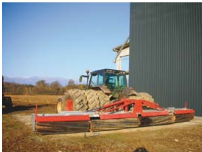
Fig. 4 - Accoppiamento realizzato da trattore ad elevata portanza con ruote gemellate e rullo "rotolama" per operazioni di gestione dei residui e livellamento in risaia.
